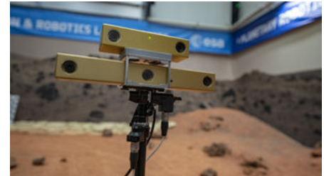
Figura 1. Sistema de cámaras integradas en el ExoTeR. Crédito: ESA
