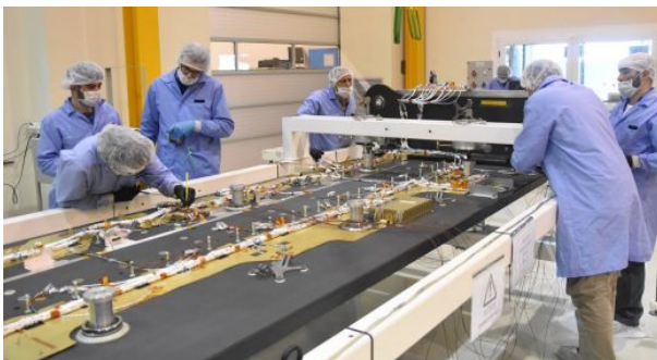
Figura 2. Parte del proceso de construcción del satélite SAOCOM-1A. Crédito: CONAE
